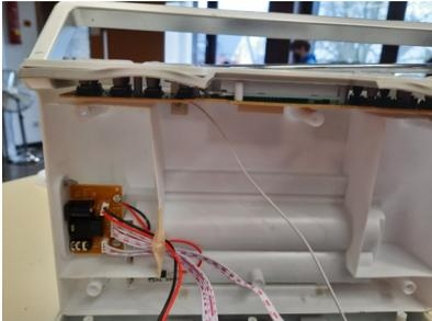
2.Schritt: Danach die Schraube im Batteriefach lösen.
